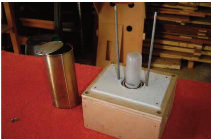
Le corps est en ctp de 19mm. Deux trous de chaque côté permettent de maintenir le fer avec des presses ou des serre-joints.
