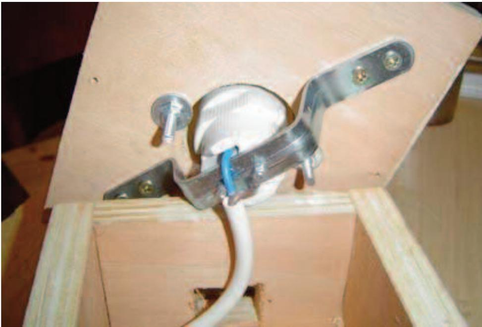
Détail de la fixation de la douille : celle-ci doit impérativement être en céramique, car la chaleur dégagée à l'intérieur est importante.
